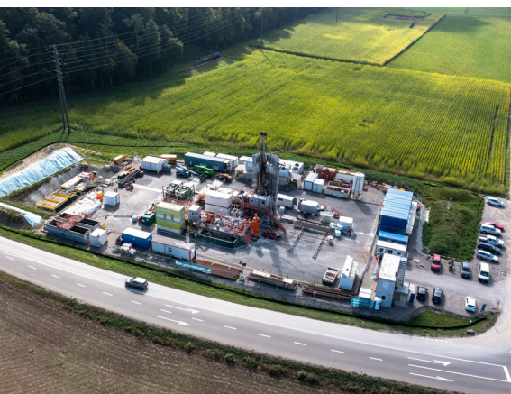
Tiefbohrung in Rheinau für Messungen in der Gesteinsformation Opalinuston (Bild: Nagra).
